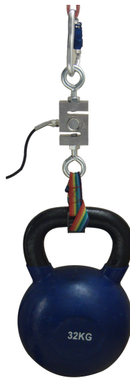
Figura 5.37: Calibración del sensor de fuerza
